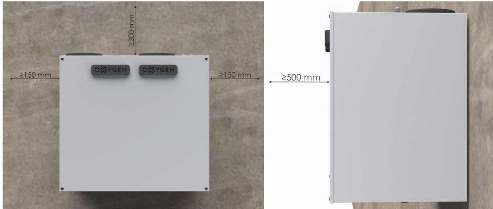
Zdjęcie 3. Przestrzeń serwisowa – seria V
