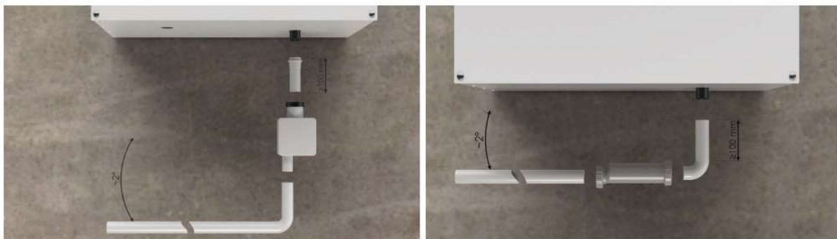
Zdjęcie 6. Podłączanie odpływu kondensatu – wymagane spadki, odległości
