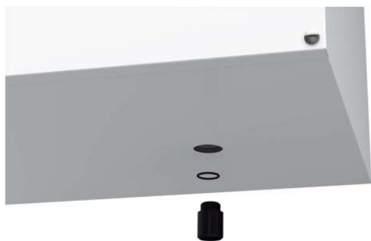
Zdjęcie 5. Montaż gwintu - seria V i seria C
