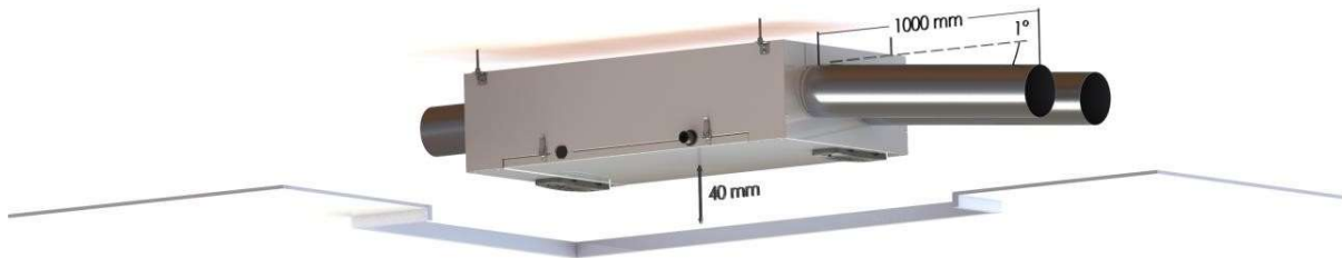
Zdjęcie 3. Zalecany spadek – kanały czerpni i wyrzutni
